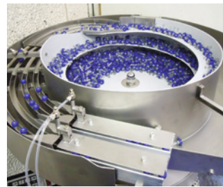
Stufenförderer mit Bunker Step feeder with bunker
